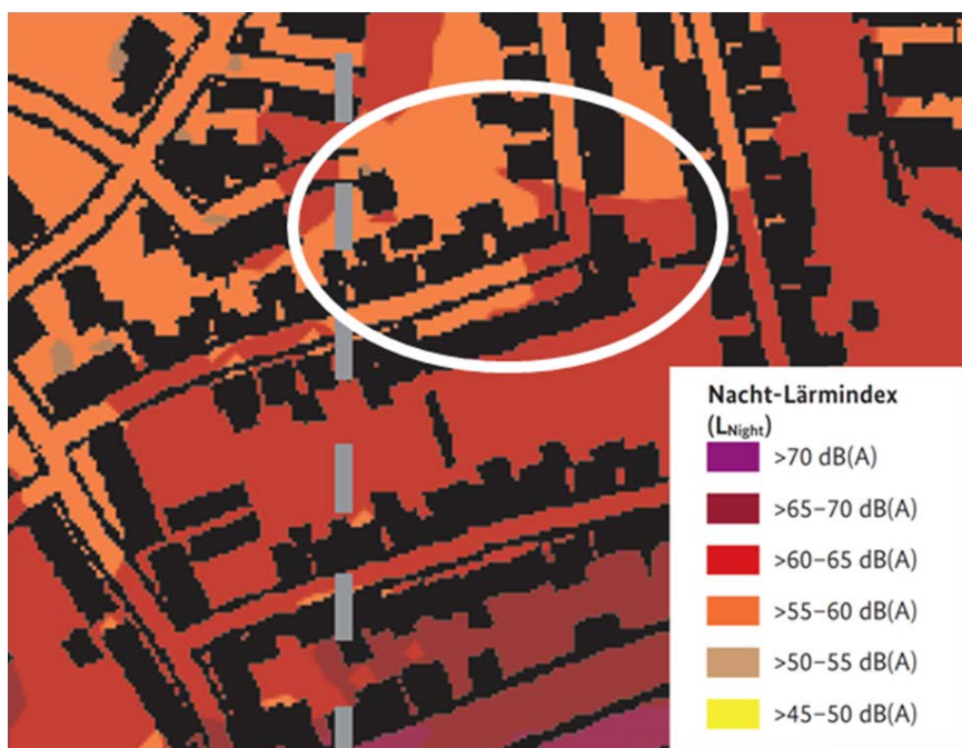
Isophonenbänder „Nacht“ (L night = von 22:00 Uhr bis 6:00 Uhr über das ganze Jahr gemittelter Dauerschallpegel); Plan genordet ohne Maßstab; Lage der 1. vereinfachten Änderung des Bebauungsplans Nr. 127 schematisch ergänzt durch weißen Kreis
