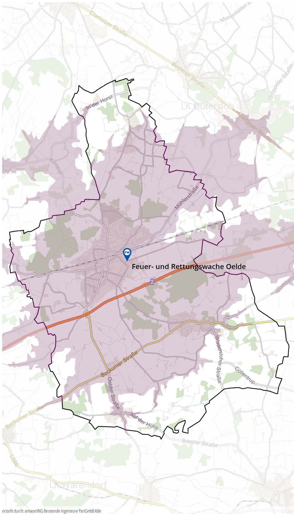
Abbildung 3.5: Isochronen des Einsatzleitfahrzeuges (ELW 1) ausgehend vom Standort der Feuer- und Rettungswache Oelde.
