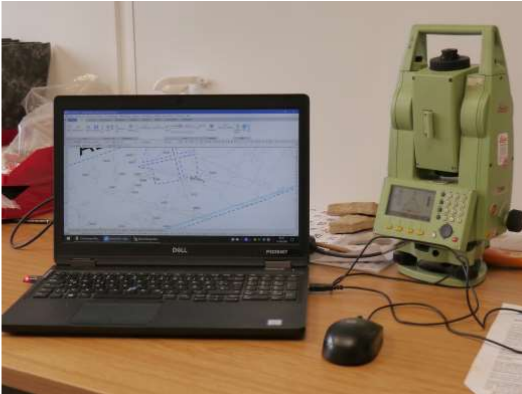
Auslesen der Tachymeterdaten auf den Rechner in AutoCad
