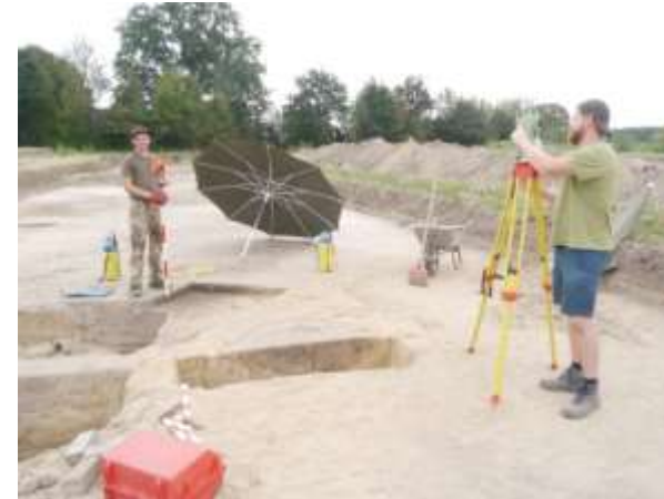
Befundeinmessung mit dem Tachymeter
