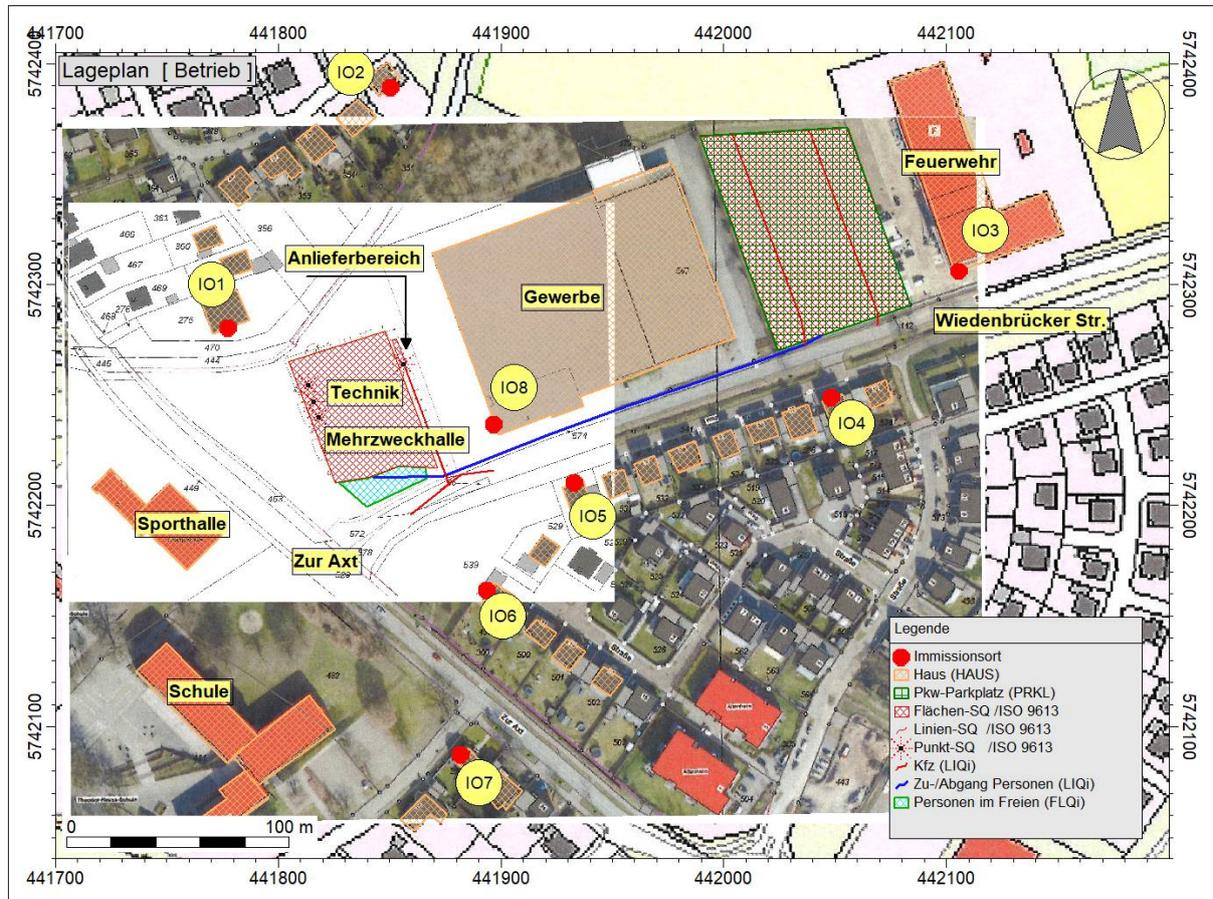
Planinhalt: Betrieb der geplanten Mehrzweckhalle an der Wiedenbrücker Straße in Oelde zur Tages- und Nachtzeit mit Schallschutzmaßnahmen
