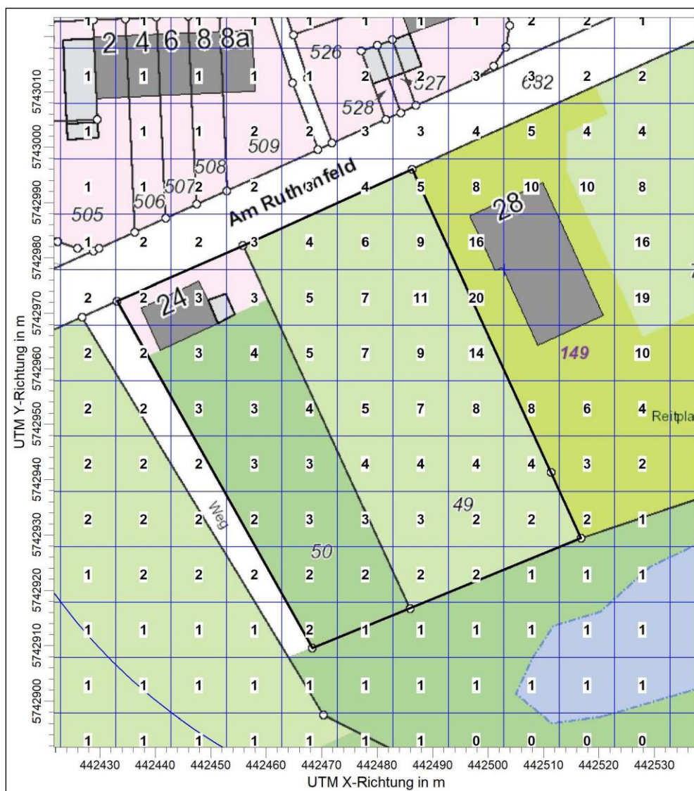
Abb. 6: Geruchsstundenhäufigkeiten in Prozent der Jahresstunden (belästigungsrelevante Kenngröße), Raster 10 m x 10 m
