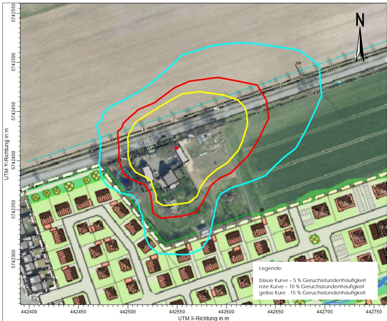
Abbildung 4: Richtlinienabstände nach VDI 3894-2 für Geruchsstundenhäufigkeiten von 5 % (Blau), 10 % (Rot) und 15 % (Blau)
