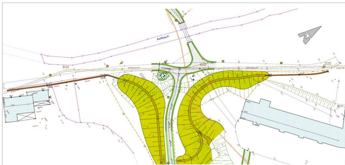
Abbildung 14: Wallanlagen zur Abgrenzung der Albert-Schweizer-Schule und der Gesamtschule (Quelle: Stadt Oelde)
