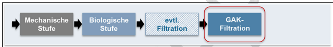
Abbildung 33: Einfaches Grundfließschema der Abwasserreinigung mit GAK-Filtration
