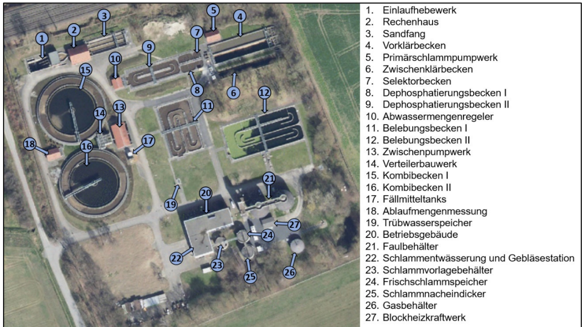
Abbildung 3: Aufbau der Kläranlage Oelde mit nummerierten Anlagenenteilen
