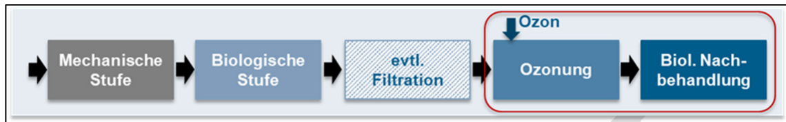
Abbildung 34: Einfaches Grundfließschema der Abwasserreinigung mit Ozonung
