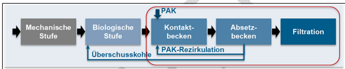
Abbildung 31: Einfaches Grundfließschema der Abwasserreinigung mit „Ulmer Verfahren“
