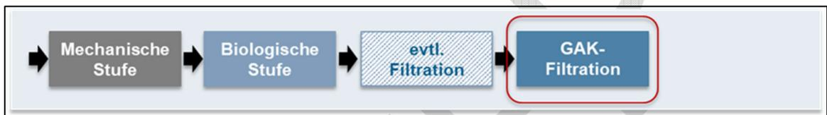
Abbildung 33: Einfaches Grundfließschema der Abwasserreinigung mit GAK-Filtration
