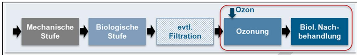
Abbildung 34: Einfaches Grundfließschema der Abwasserreinigung mit Ozonung
