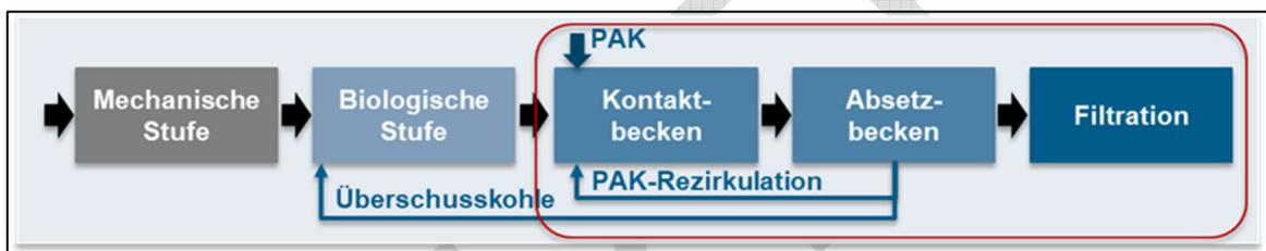
Abbildung 31: Einfaches Grundfließschema der Abwasserreinigung mit „Ulmer Verfahren“
