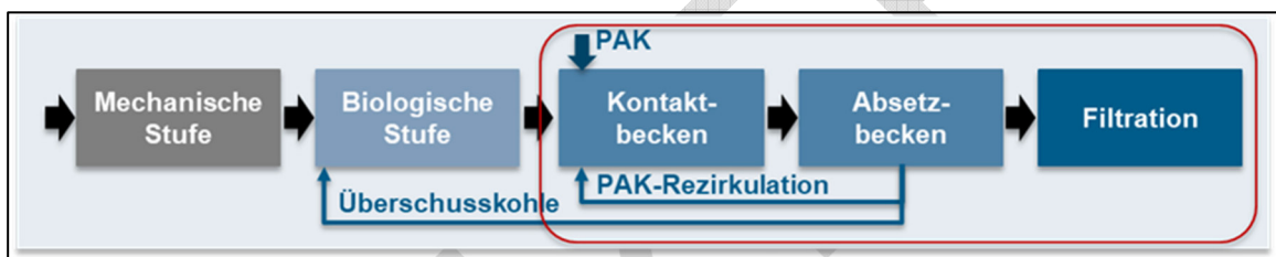
Abbildung 31: Einfaches Grundfließschema der Abwasserreinigung mit „Ulmer Verfahren“
