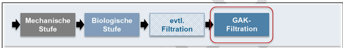
Abbildung 33: Einfaches Grundfließschema der Abwasserreinigung mit GAK-Filtration
