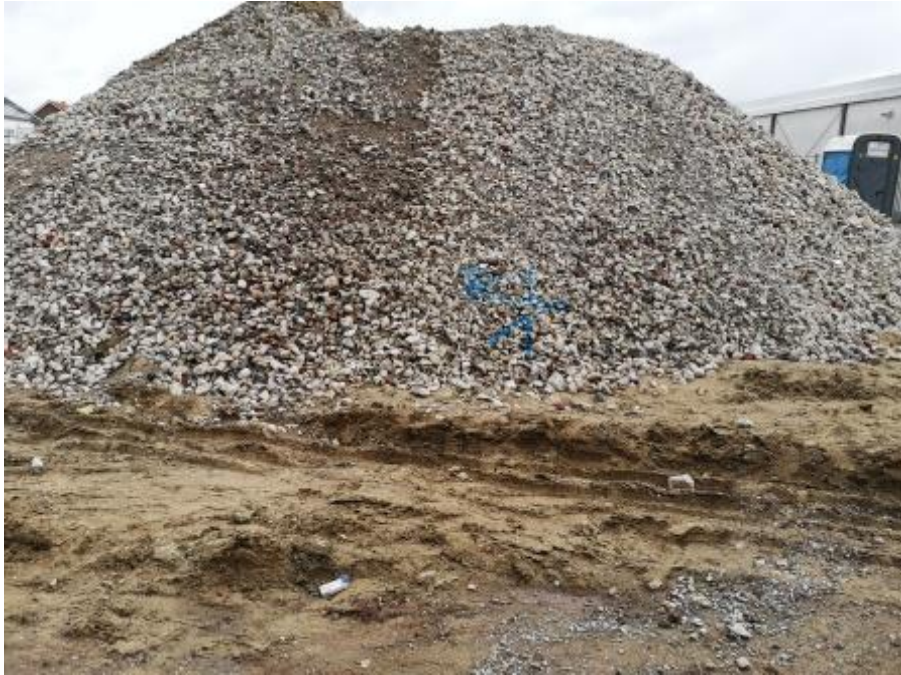
Foto 21: Blick auf das gewonnene RCL-Material. Probenahme von Mischprobe „RCL I“.
