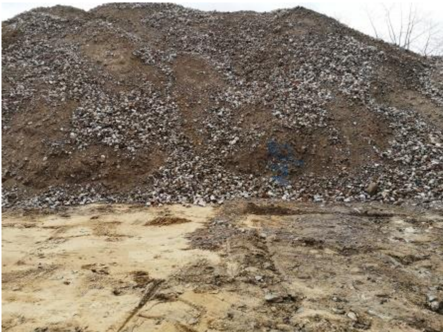
Foto 22: Blick auf das gewonnene RCL-Material. Probenahme von Mischprobe „RCL II“.
