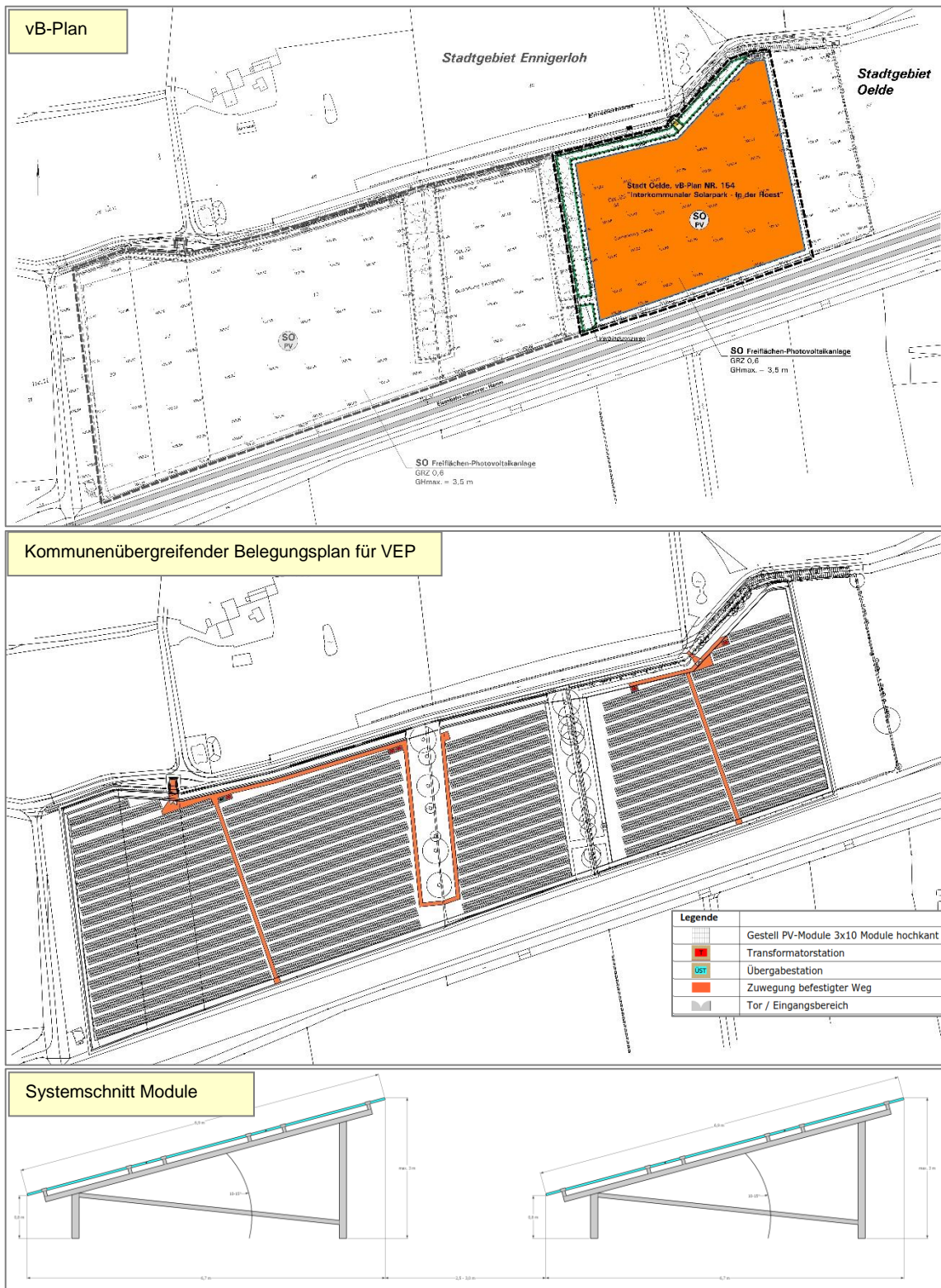
Abb. 5 Ausschnitt aus dem vB-Plan (oben), dem kommunenübergreifenden Belegungsplan für den „Interkommunalen Solarpark – In der Hoest“ (Mitte) (Stand: Entwurf Offenlage Juni 2023) sowie Systemschnitt der Module
