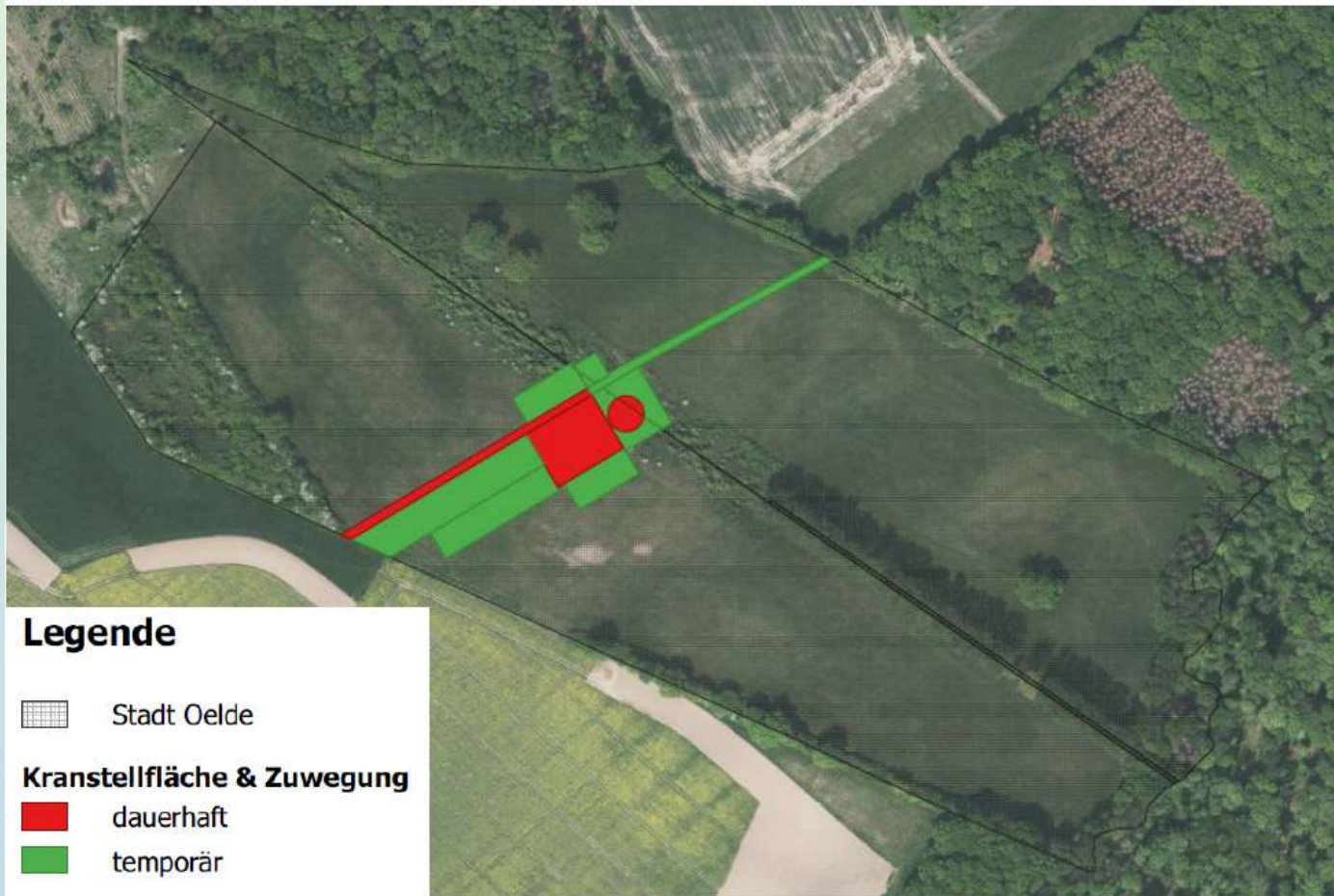
Abb. 2 Lage der geplanten WEA auf der Ausgleichsfläche mit dauerhaft und temporär beanspruchten Flächen
